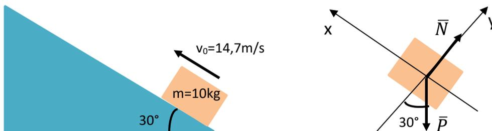
a) Para resolver el problema debemos plantear la 2° Ley de Newton, pero vemos que la fuerza Peso no se encuentra en la dirección de ninguno de los ejes. Entonces la descomponemos en sus componentes:
